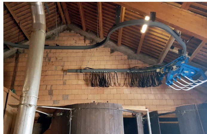
↑ Die Kurvenfahrwerke können vor Ort mit der mobilen Biegeeinrichtung perfekt an die Gegebenheiten angepasst werden.
