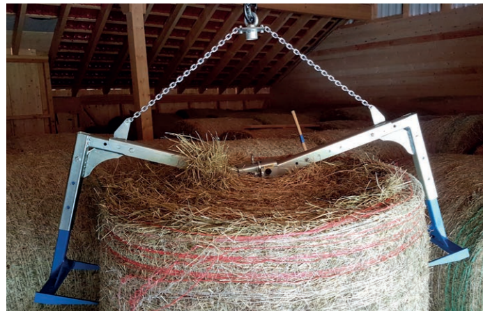
↑ Universal-Ballenzange, verstellbar für alle gängigen Ballenarten.
