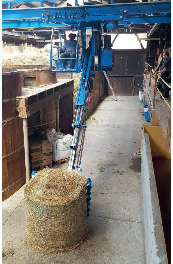
↑ Optional mit Rotator und Greiferhochstellung 135° Ideal für Rund- und Quaderballen.
