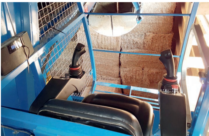
↑ Proportionalhydraulik mit Joysticksteuerung
