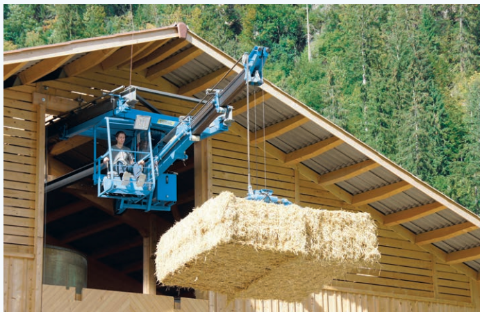
↑ Seilzug mit 1000 kg Hubkraft und Greiferhochstellung – auch optimal geeignet für Silos
