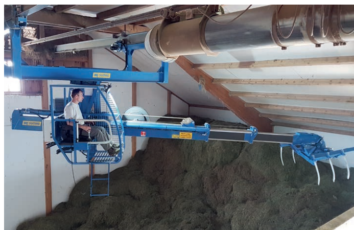
↑ Höhenversetzte Fahrwerke für optimale Anpassung an bestehende Gebäude oder Kombination zu Teleskopheverteiler.
