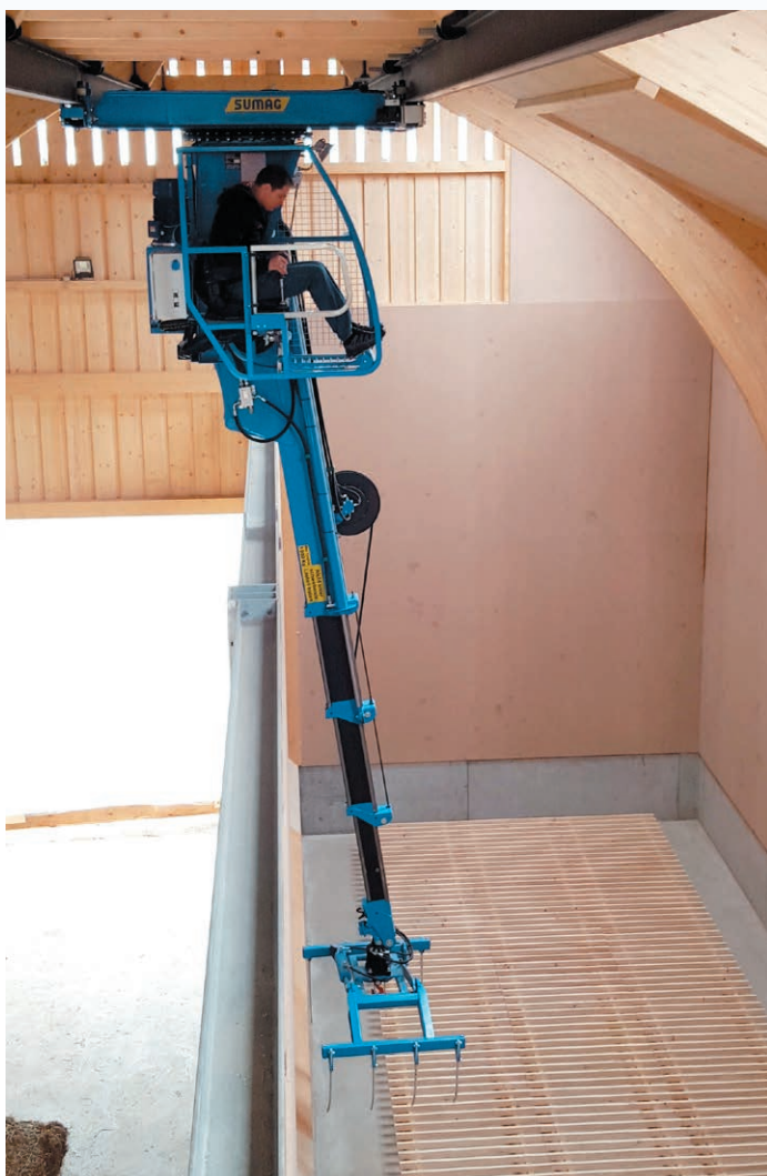
↑ Spezielle Krangeometrie ohne tote Winkel sorgen für beste Sicht entlang der Heuwand
