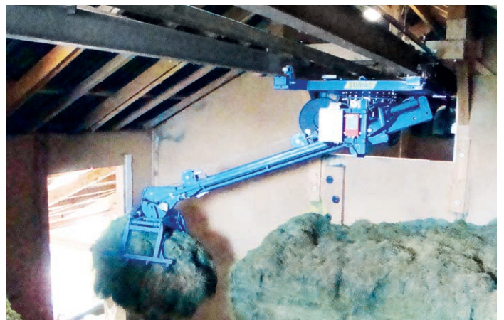
↑ Auch mit niedriger Gesamtbauhöhe (1.20 m) ohne Kabine und Funkfernsteuerung möglich
