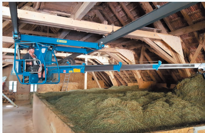
↑ Fahrwerksbreite auf Mass ermöglichen den Einbau in fast jedes Gebäude.
