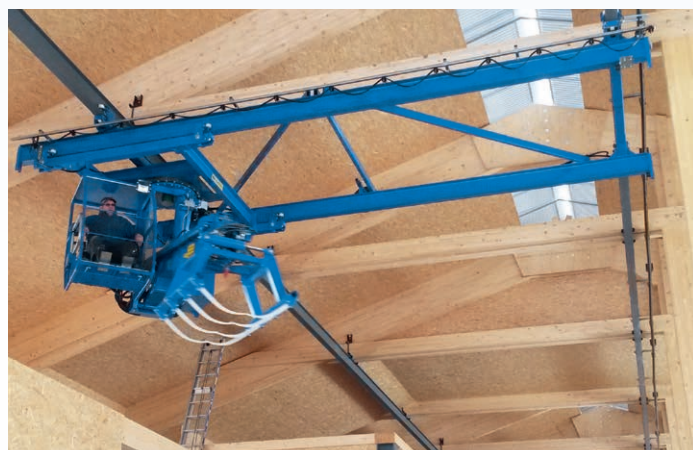
↑ Seitenfahrwerke erweitern den Einsatzbereich.
