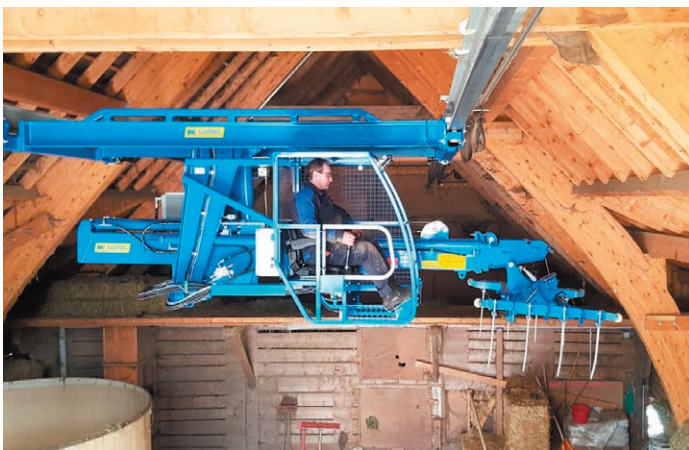
↑ Eine nach vorne versetzte Kabine ermöglicht eine perfekte Übersicht bei der Silobewirtschaftung
