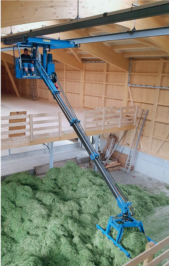
↑ Reichweite bis 14 m Hubmoment: 5,5 bis 8 mt
