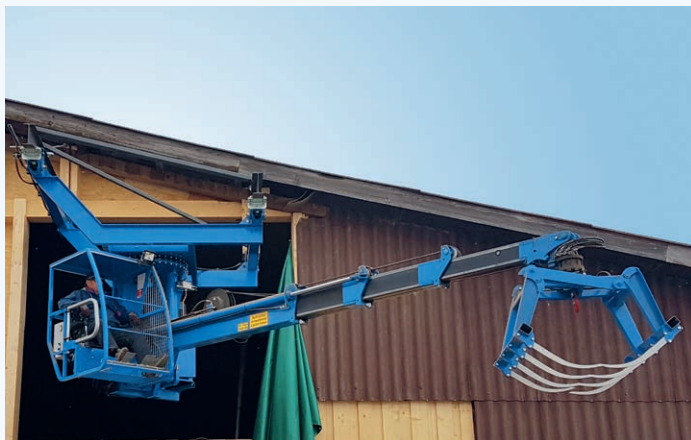
↑ Einseitig höhenversetzte Fahrwerke für Scheunen mit Pultdach.
